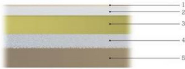
Figur 2: En platta på mark består normalt av flera skikt och en principiell uppbyggnad är: 1. Golvbeläggning 2. Betongplatta 3. Värmeisolering 4. Kapillärbrytande skikt (singel, makadam) och 5. Mark.
